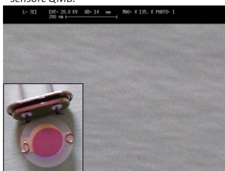
Immagine al SEM di un film di porfirine E immagine macroscopica del film su un sensore QMB.
